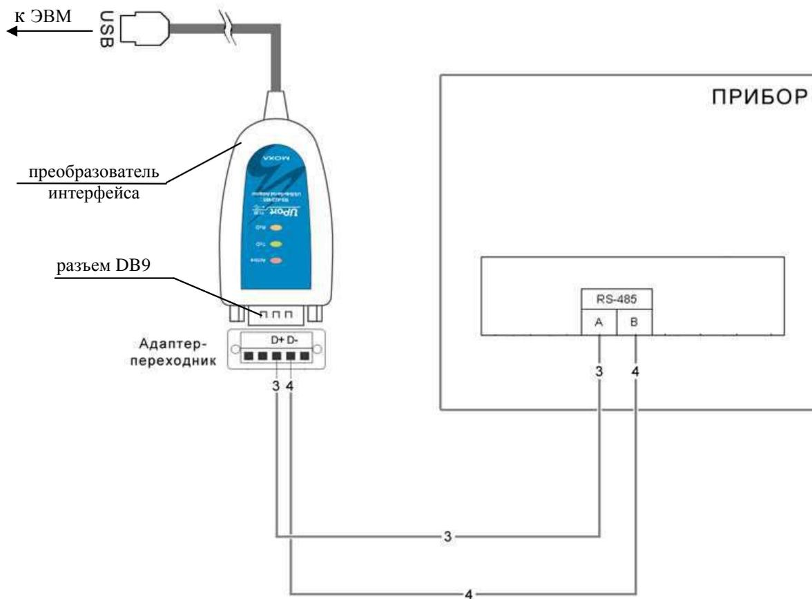
Рисунок В.1 — Схема подключения ПИ
